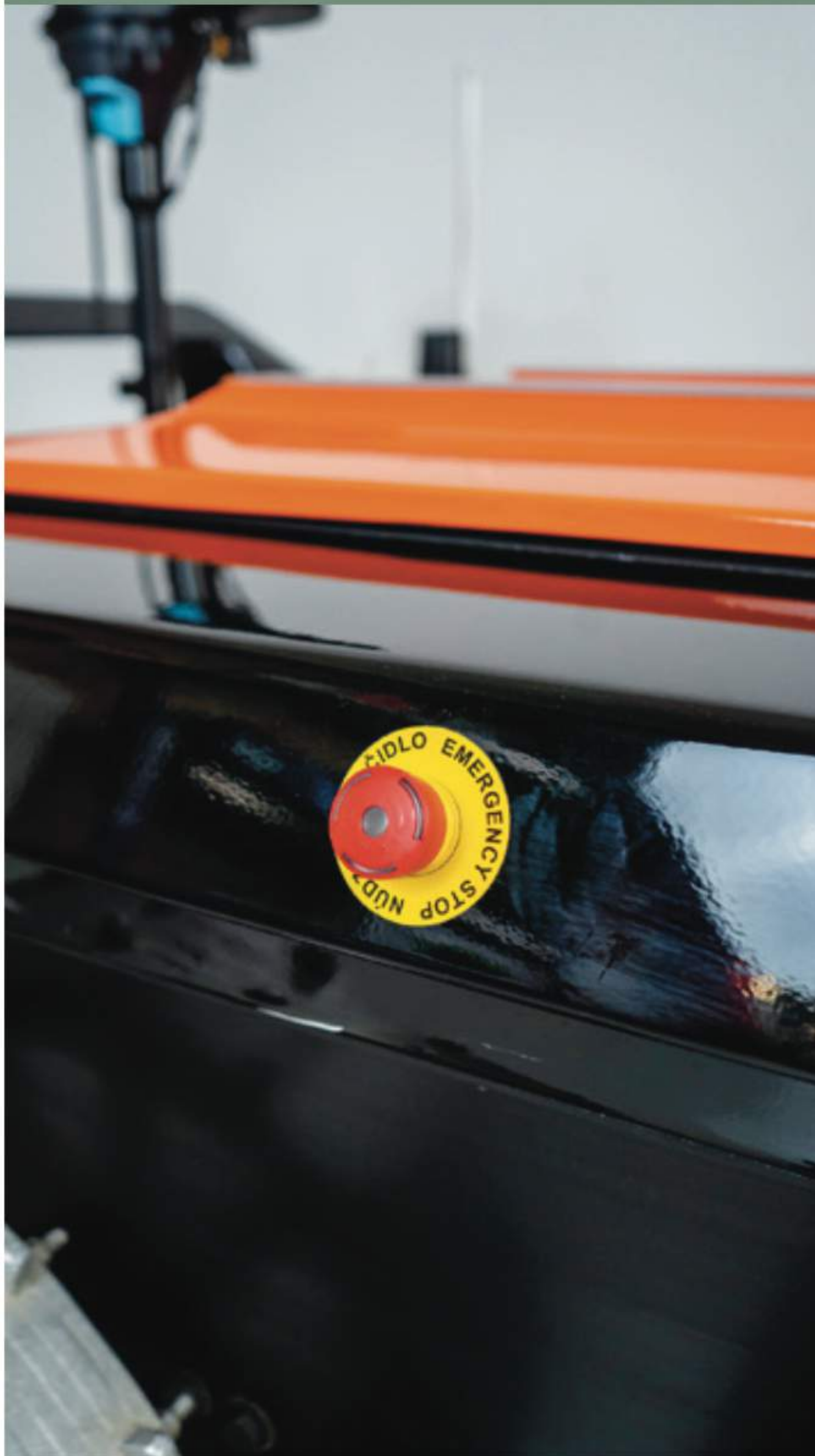
Interruptor de emergencia
